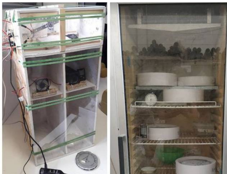
Fig. 3: A sinistra prototipo sperimentale per la misura automatizzata con cicli personalizzabili a destra test dei materiali in camera climatica
