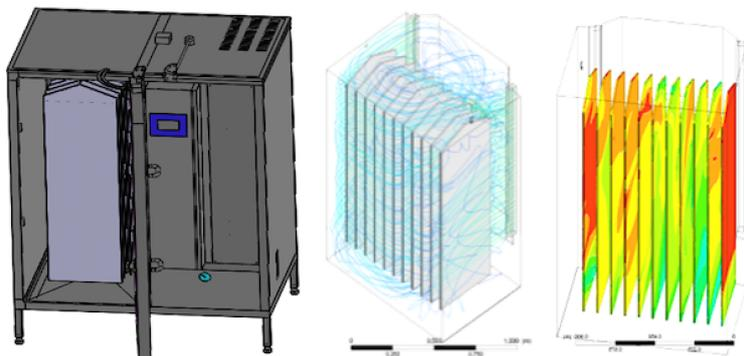
Fig. 2: Cabina studiata e simulata fluidodinamicamente
