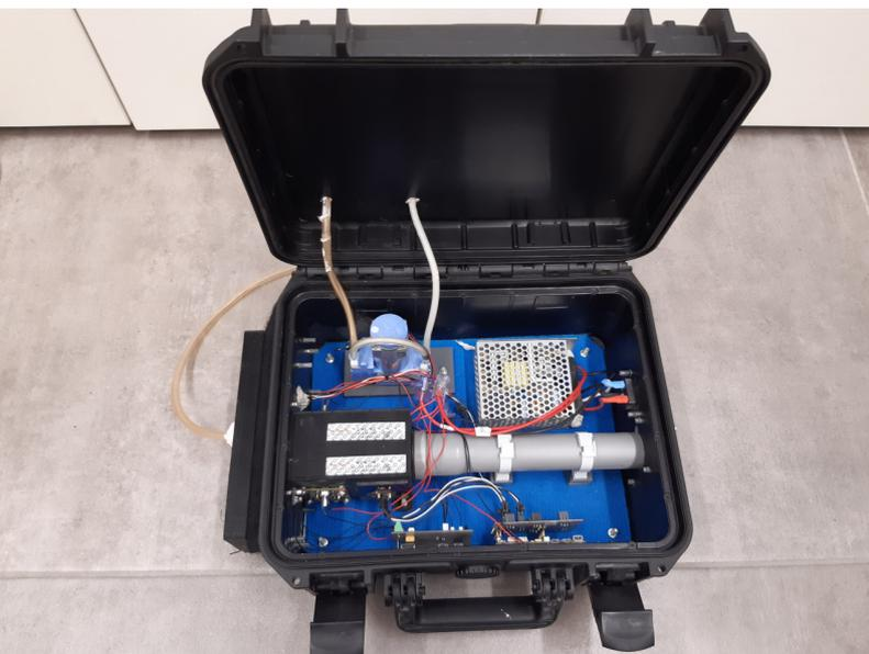
Fig. 2: Prototipo della stazione di monitoraggio ammoniacca - vista interna
