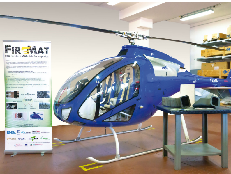
Fig. 3: Cofano turbina in Laminato Composito Metallo (elemento color alluminio), dimostratore del progetto FireMat, montato su elicottero Zephyr di Curti Costruzione Meccaniche
