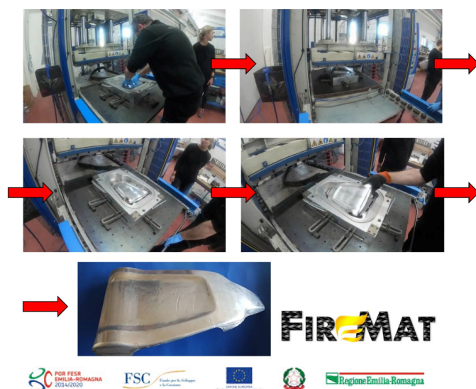
Fig. 1: Processo di pressatura a caldo di FML in forma complessa, effettuata utilizzando stampi e linea messa a disposizione dal partner del progetto Bucci Composites
