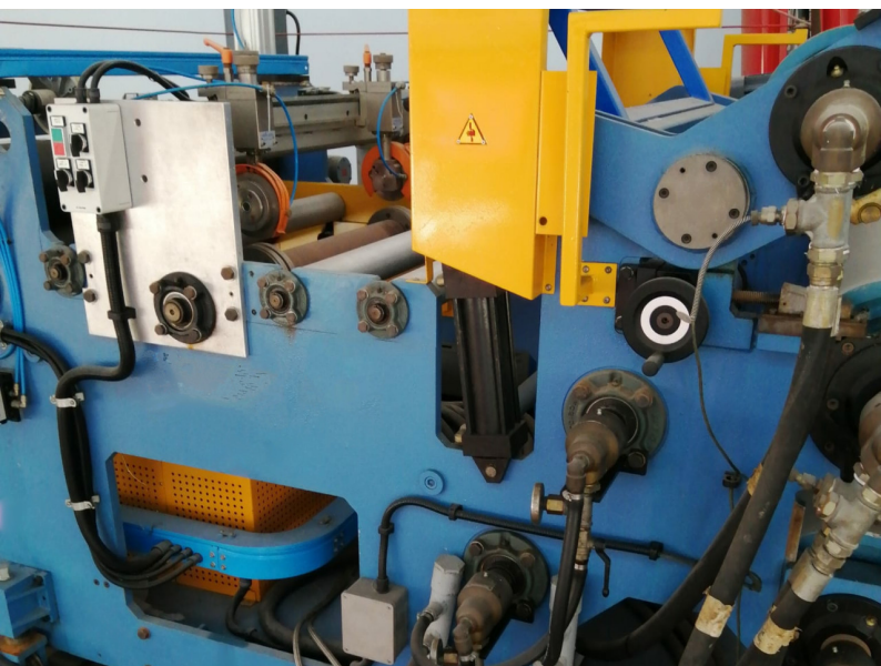
Fig. 2: Linea pilota SMC e calandratura a caldo, acquisita in ENEA-TEMAF grazie ai fondi del progetto FireMat, per lo sviluppo di nuovi FML basati su fibra corta e a migliore sostenibilità
