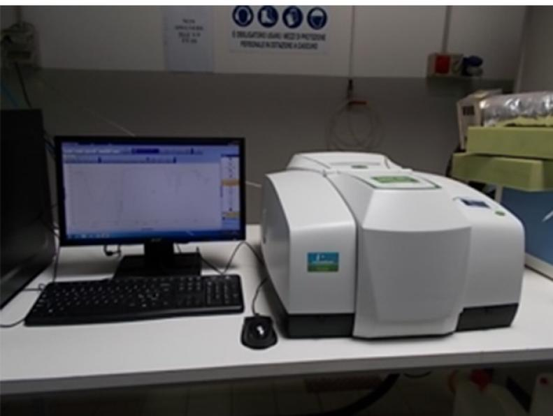
Fig. 2: Spettrofotometro FTIR con sfera integrante
