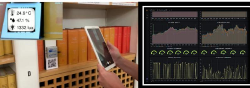
Fig. 3: Monitoraggio in tempo reale di parametri ambientali in una biblioteca mediante la lettura dei dati provenienti da sensori IoT.
