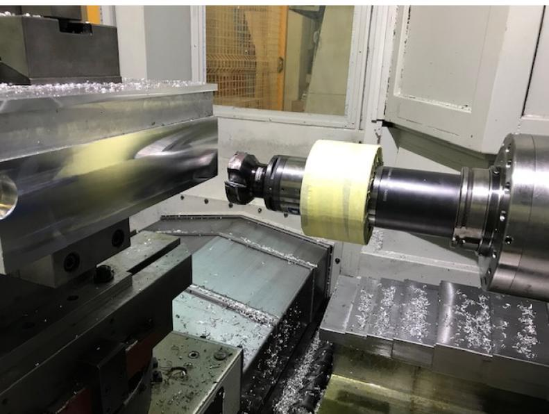
*Fig. 3: Utensile sensorizzato durante il test su macchina fresatrice a controllo numerico. Il nastro bianco visibile è applicato su una protezione per il sensore e l'elettronica realizzata in stampa 3D.*
