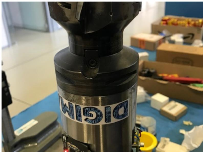
Fig. 1: Utensile rotante sensorizzato per lavorazioni meccaniche su macchine cnc.
