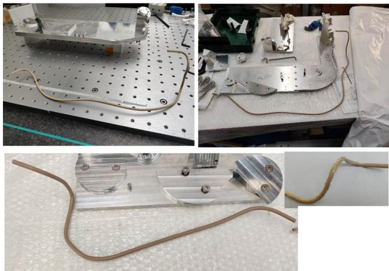
Fig. 1: Esempi di Peek tube a forma complessa
