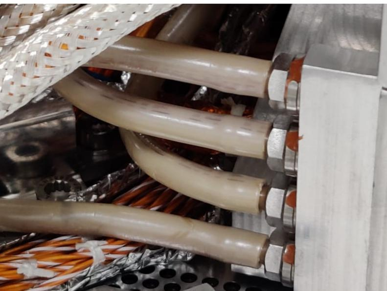
Fig. 2: Esempio di tubi in peek a geometria complessa
