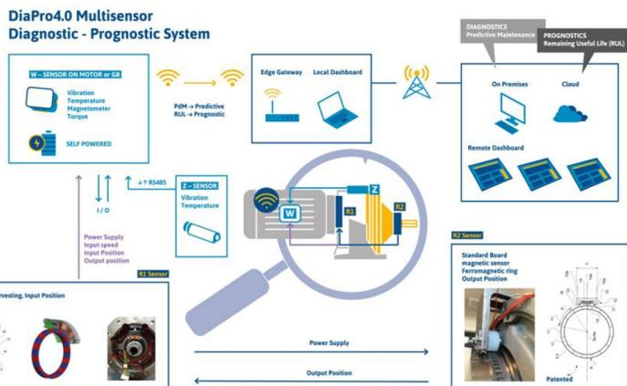
Fig. 3: Sistema multi-sensore di Diagnostica-Prognostica DiaPro4.0
