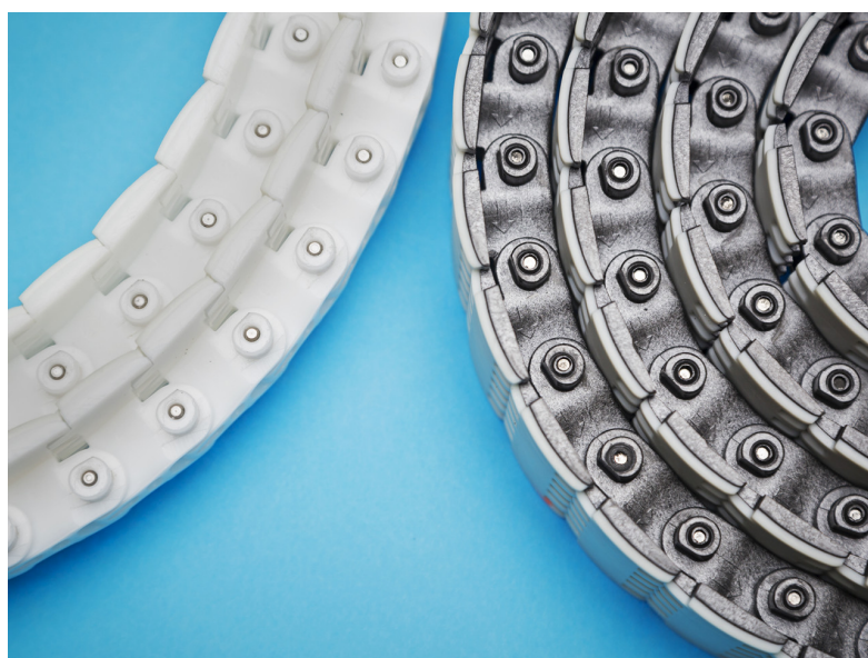
Fig. 1: Catena di trasporto per macchine automatiche da packaging ottenuta con stampaggio a iniezione bimateria di un polimero strutturale e un elastomero per aumentare il grip sul prodotto.
