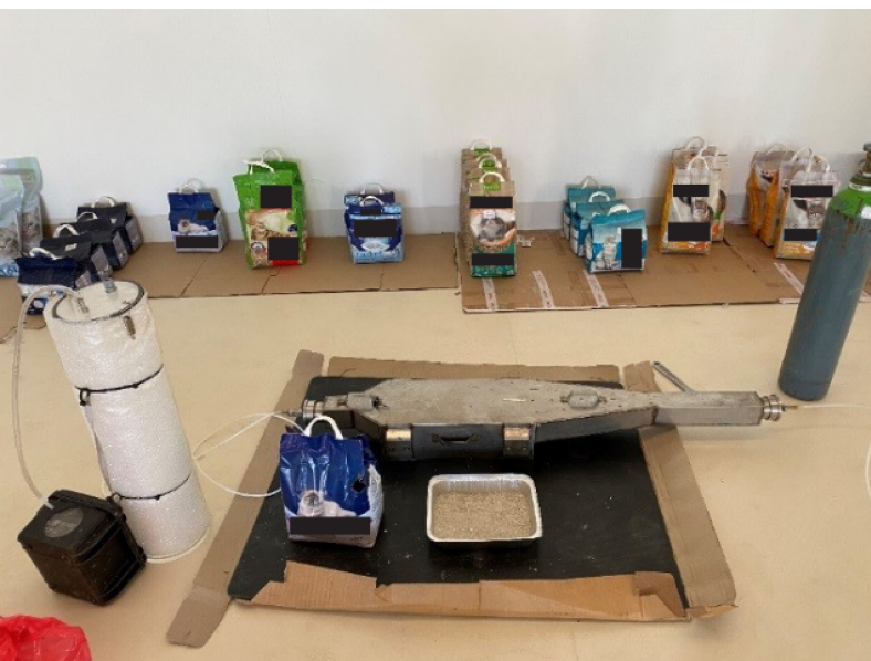
Fig. 2: Campionamento odorigeno di una lettiera per gatti, tramite Wind Tunnel
