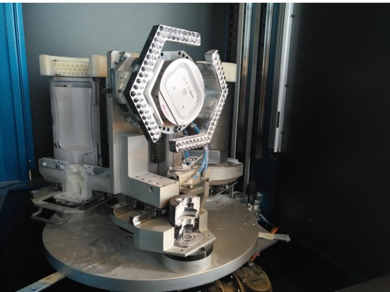
Fig. 3: Stampo finitore installato in macchina durante controllo.
