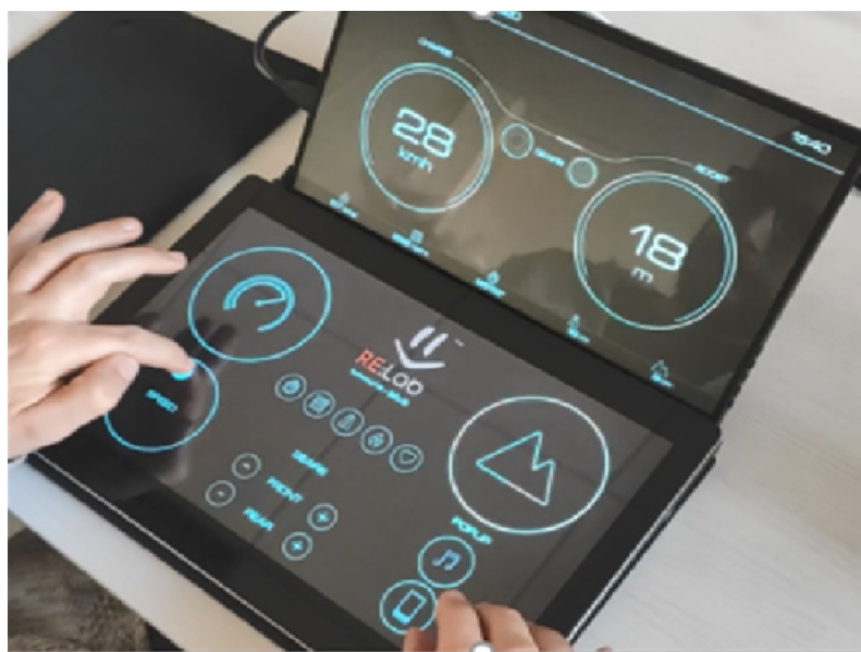
Fig. 1: Piattaforma software costruita in model-based che mostra nella parte superiore il sistema di visualizzazione del programma di allenamento, mentre in quella inferiore l'interfaccia di controllo.
