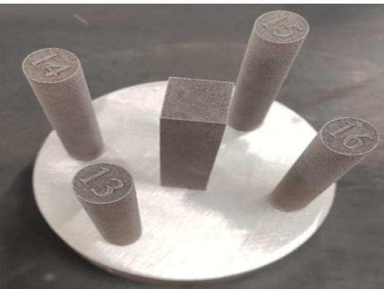
Fig. 2: Campioni di AlSi10Mg per prove di trazione, metallografia e durezza realizzati tramite tecnologia SLM con stampante SISMA Mysint100
