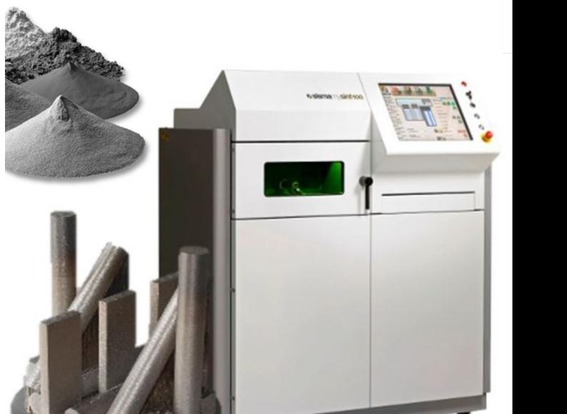
Fig. 1: Esempio di campioni e polveri processati tramite tecnologia SLM con stampante SISMA mysint100
