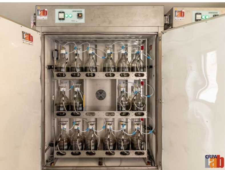
Fig. 3: Sistema di misura del potenziale metanigeno di biomasse (test BMP) presso il CRPA Lab
