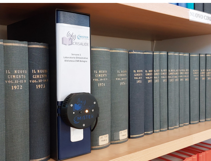
Fig. 2: Il sensore Msense-THL-0-1 installato presso il laboratorio dimostrativo Progetto CRISALIDE, monitora in tempo reale i parametri ambientali della Biblioteca dell'Area del CNR di Bologna.
