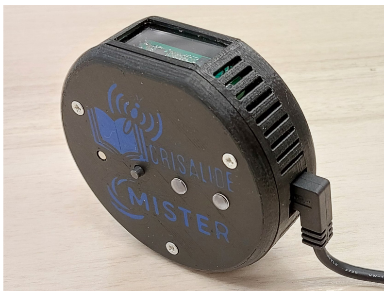
Fig. 1: Il sensore ambientale Wi-Fi Msense-THL-0-1 è stato pensato per il monitoraggio del patrimonio culturale
