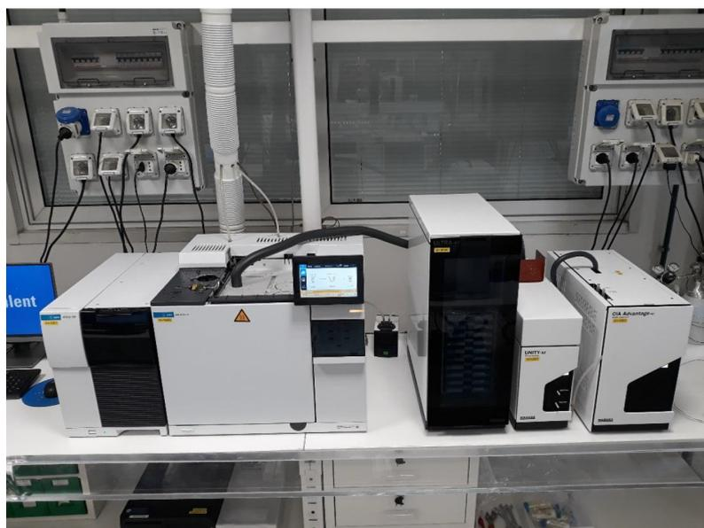
Fig. 1: Sistema termodesorbitore GC-MS
