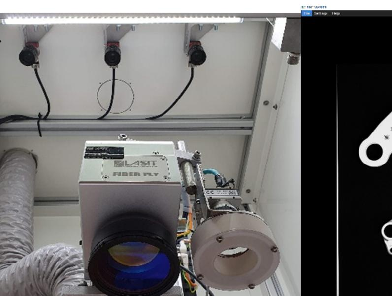
Fig. 2: Array di camere installate all'interno della marcatrice LASIT, GUI del Software MUSP per controllo macchina e riconoscimento dei pezzi
