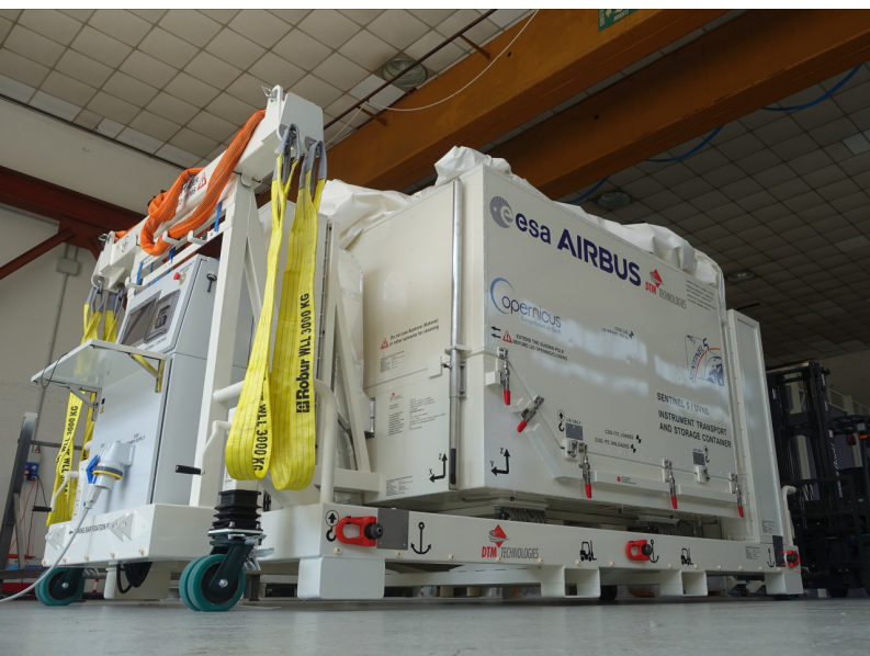
Fig. 3: Transport container per strumenti per satelliti (Sentinel 5)
