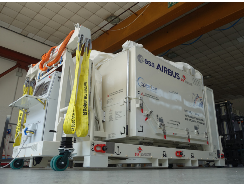
Fig. 2: Transport container per strumenti per satelliti (Sentinel 5)
