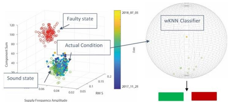
Fig. 1: Classificatore statistico delle feature impiegate per scopi diagnostici
