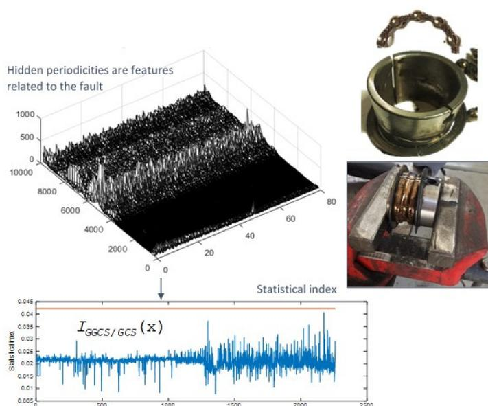
Fig. 2: Diagnostica dell'usura di cuscinetti volventi: andamento di una feature statistica con l'avanzamento dell'usura
