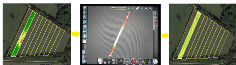
Fig. 3: Applicazione e funzionalità da NDVI a Prescription Map a NDVI del campo trattato
