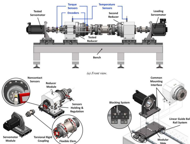
Fig. 2: struttura banco prova
