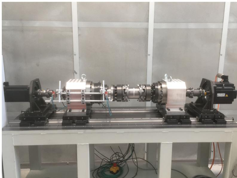
Fig. 1: banco prova per servomeccanismi e riduttori di precisione
