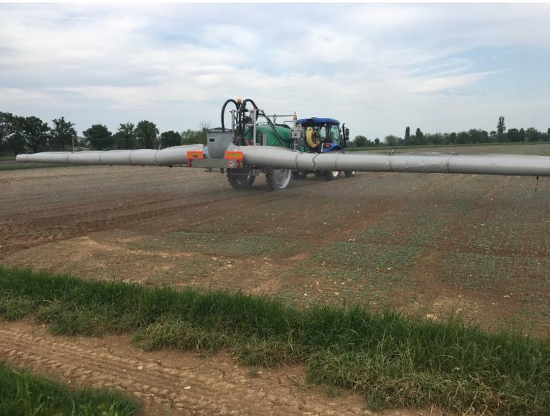
Fig. 2: Distribuzione dell'ozono in campo di basilico da industria tramite ozonizzatore
