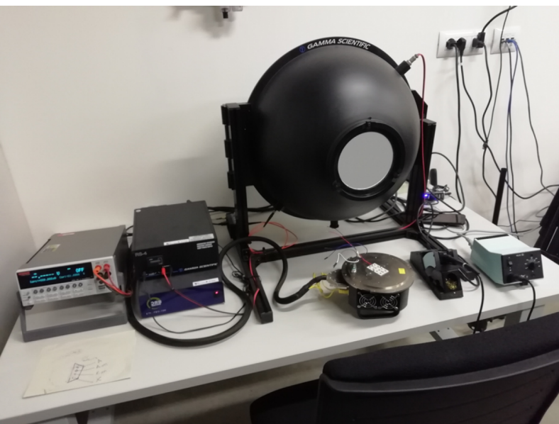
Fig. 2: Sfera integratrice per misure ETO (elettro-termo-ottiche) di sorgenti luminose
