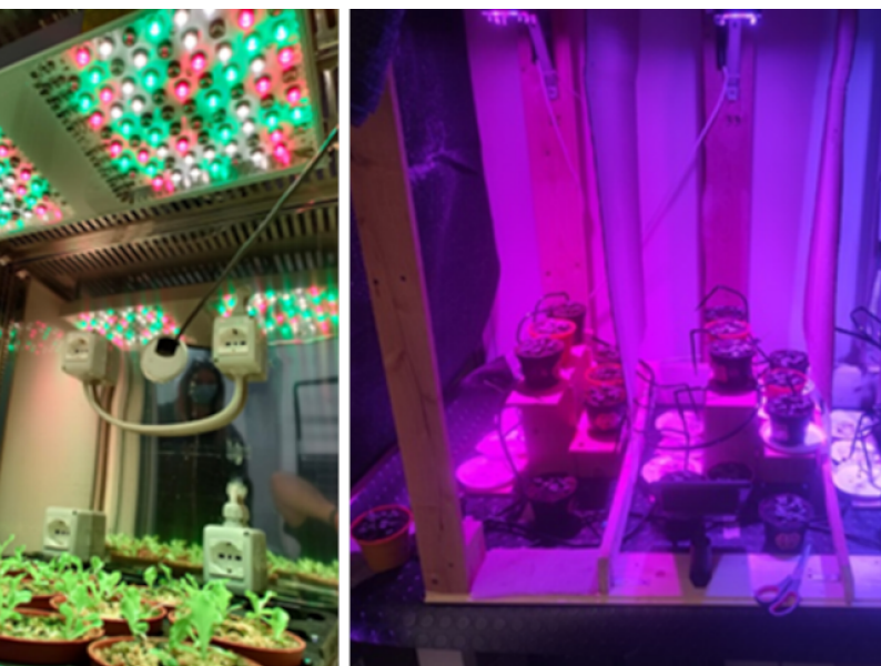
Fig. 3: Test di crescita indoor di lattughino con luce variabile in funzione della fase di crescita della pianta
