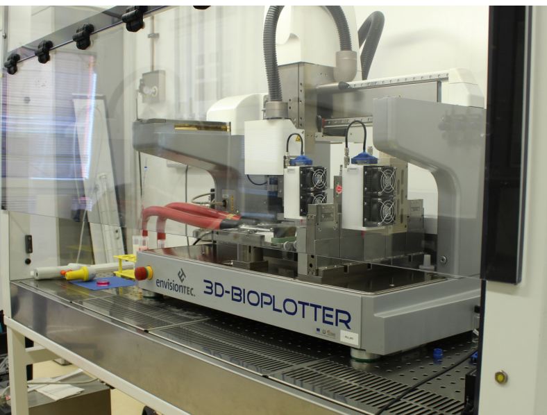
Fig. 2: EnvionTec 3D Bioplotter, strumento utilizzato per la realizzazione dei modelli in vivo
