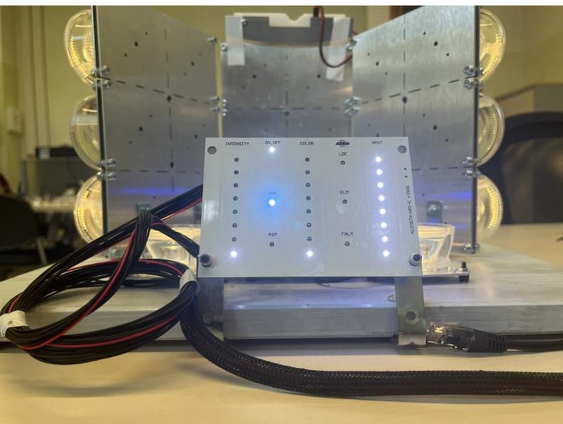
Fig. 2: Pannello di controllo utente con pulsanti capacitivi
