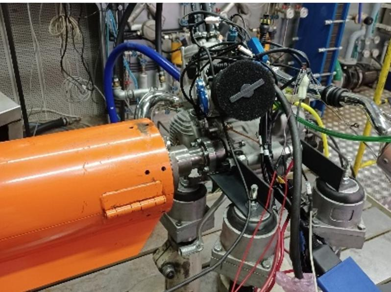
Fig. 2: Prototipo di sviluppo al banco prova
