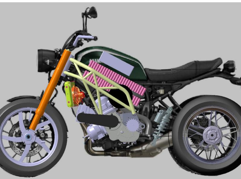
*Fig. 3: Esempio di configurazione della power unit HybridTec su moto naked.*
