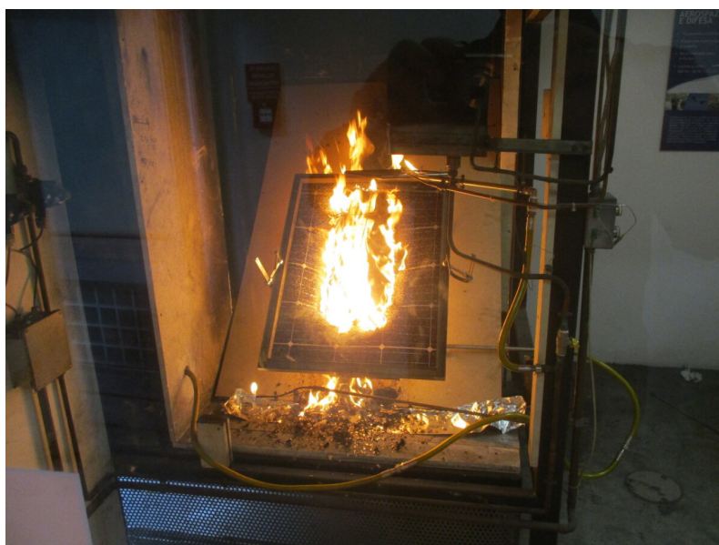
Fig. 1: Prova di reazione al fuoco su pannello fotovoltaico CEI TS 82-89
