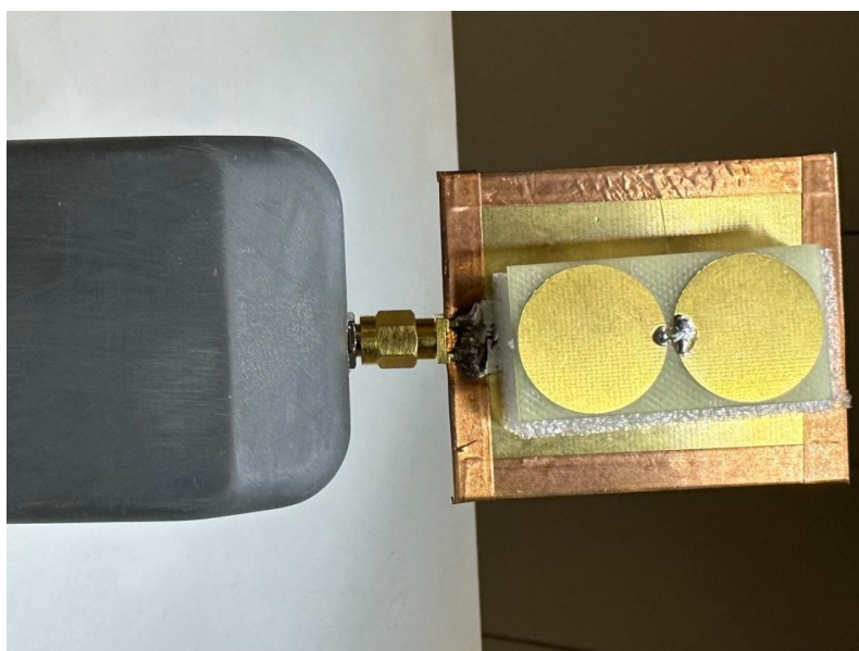
Fig. 1: Ancora UWB, portata 100mt.
