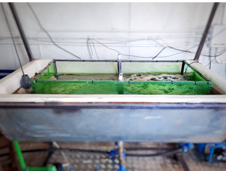
Fig. 3: Particolare del bioreattore per la macerazione microbiologica controllata disponibile presso STUARD LAB
