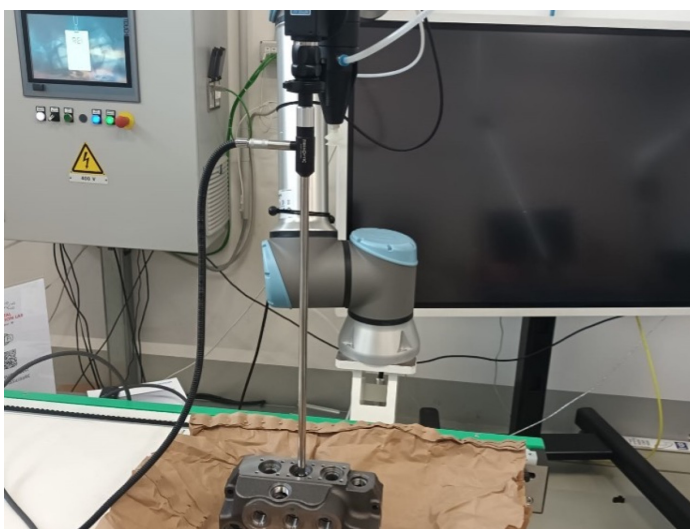
Fig. 1: Endoscopio installato su braccio robotico
