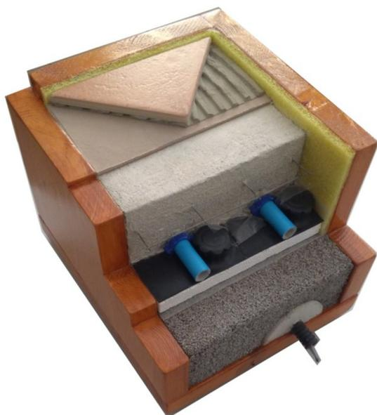
Fig. 2: Prototipo di massetto con materiale riciclato e impianto a pavimento
