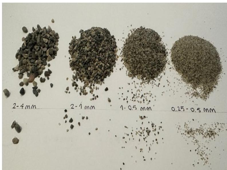
Fig. 1: La forma e la granulometria del rifiuto sono elementi essenziali per la re-immissione nel circuito produttivo
