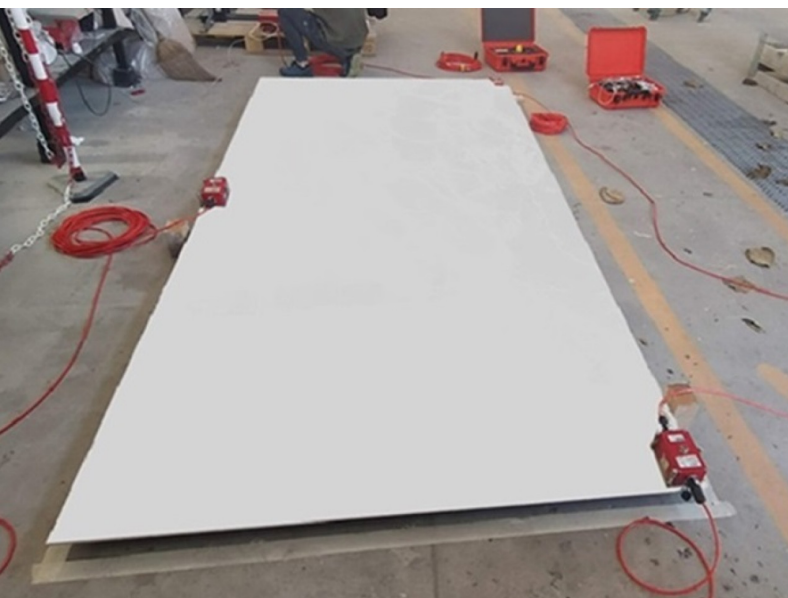
Fig. 3: Foto di prova in corso con sensori posizionati sulla piastrella da testare
