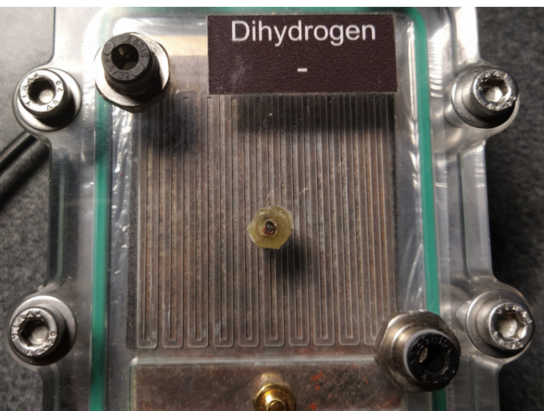
Fig. 2: Test di una cella PEM ottenuta con stampa 3D modificata.
