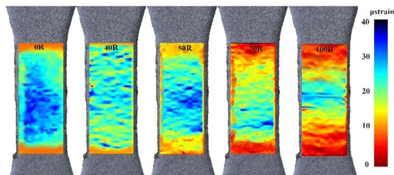
Fig. 2: Mappe di deformazione dei provini di conglomerato bituminoso
