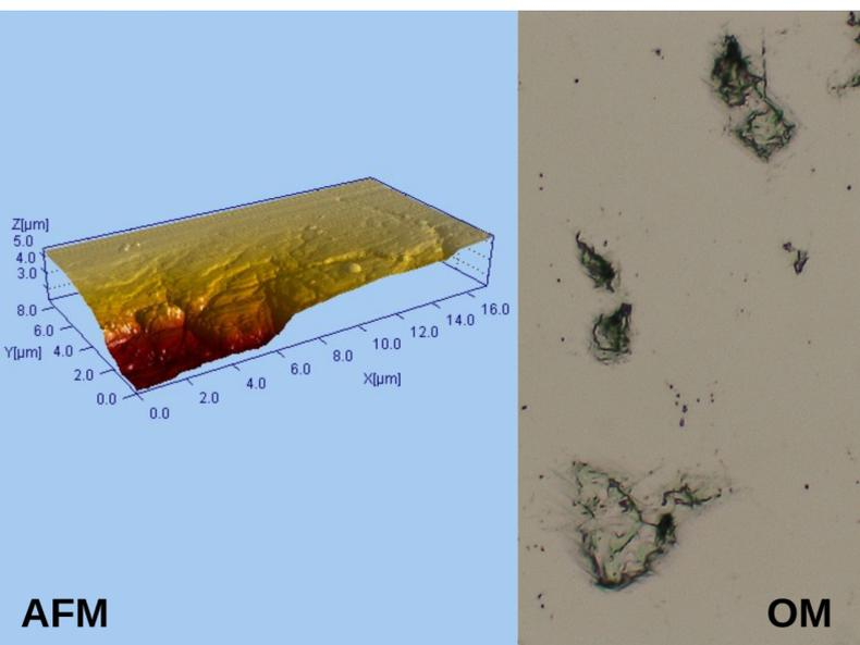
Fig. 3: Difetto di pull-out su superficie lamiera in AISI430 lucidata, osservato in AFM ed in microscopia ottica (OM, 1500X)
