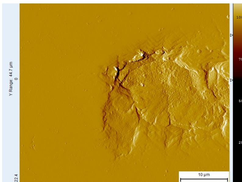
Fig. 1: Topografia AFM difetto di pull-out su lamiera AISI430 lucidata con processo meccanico
