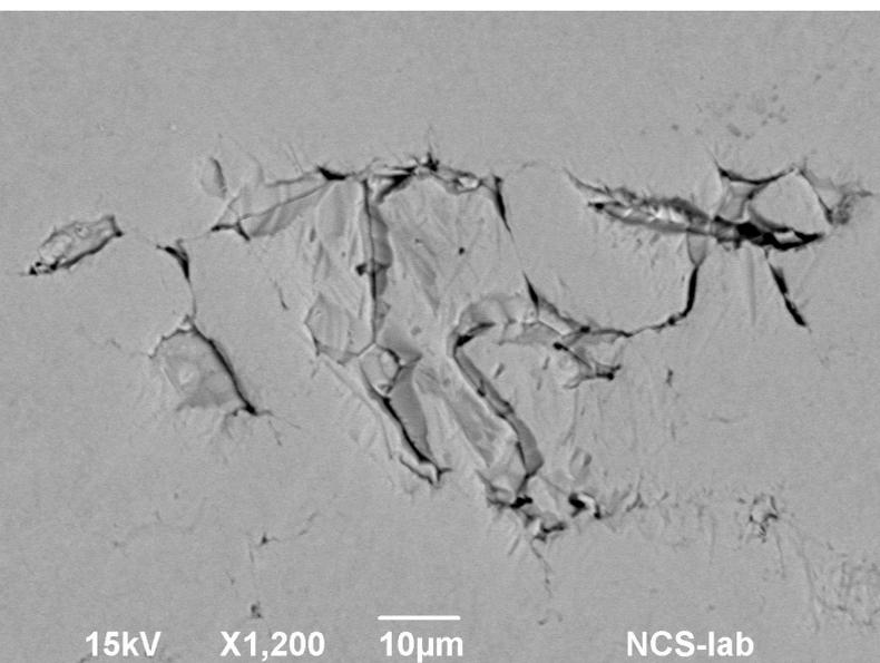
Fig. 2: Immagine SEM (BSE) superficiale di una lamiera AISI430 lucidata a specchio con processo meccanico. Sono visibili difetti di pull-out in stato iniziale.
