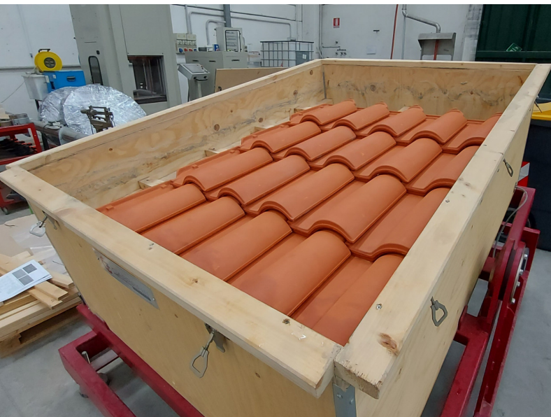
Fig. 2: Set-up sperimentale per la misura della permeabilità delle tegole
