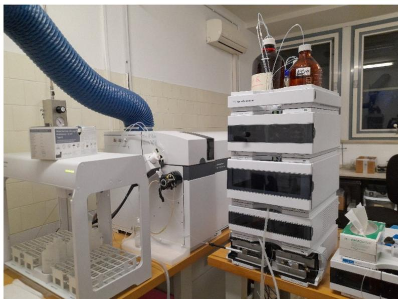
Fig. 1: Sistema HPLC bio-inert accoppiato a ICP-MS
