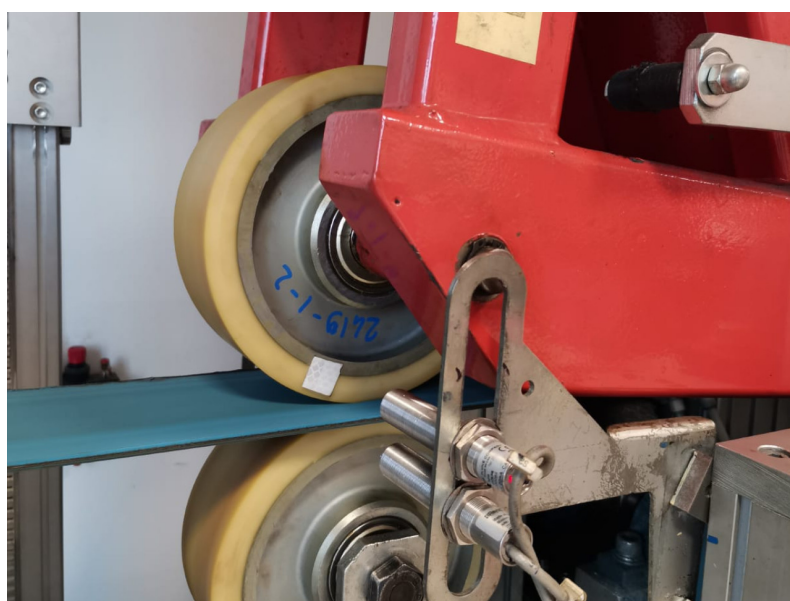
Fig. 1: Particolare del banco di prova per prove di fatica.
