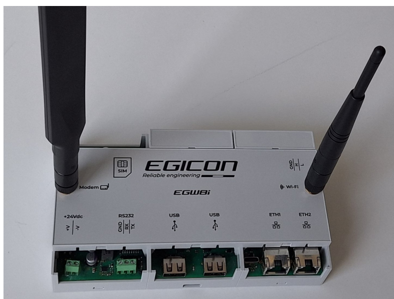
Fig. 1: EGW8i - Visione dall'alto da dove è possibile osservare le antenne e le porte (USB, Ethernet, ...)
