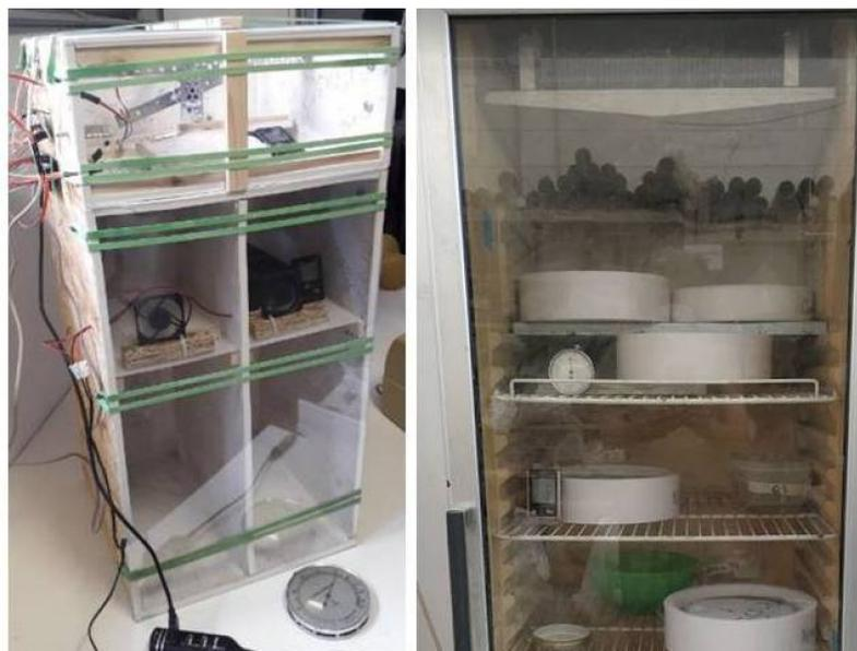
*Fig. 3: A sinistra prototipo sperimentale per la misura automatizzata con cicli personalizzabili a destra test dei materiali in camera climatica*
