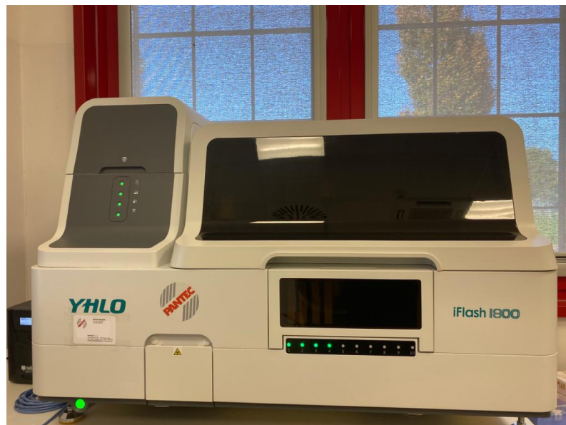
Fig. 1: Strumento iFlash 1800 (Pantec) utilizzato dalla Fondazione IRET per la rilevazione degli anticorpi anti Sars-Cov-2 (metodica CLIA)
