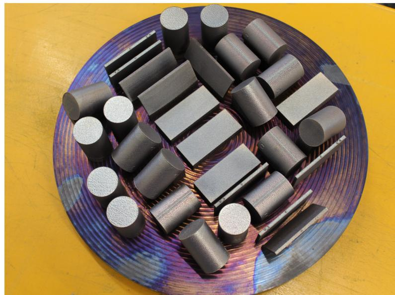
Fig. 1: Building platform e campioni dopo trattamento termico
