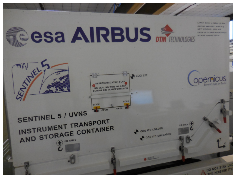
Fig. 1: Esempio di implementazione del sistema di depressurizzazione rapida
