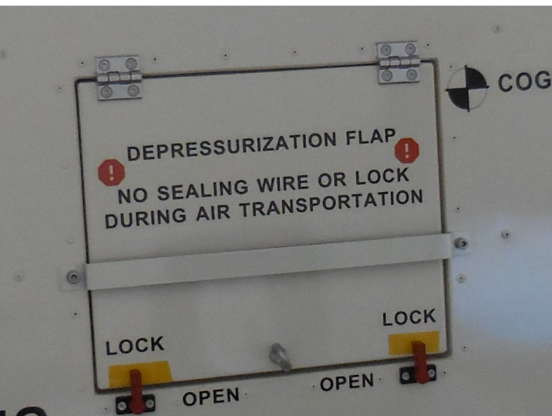
Fig. 2: Depressurization flap su sistema di trasporto aereo per strumento ottico
