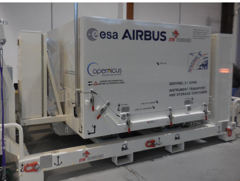
Fig. 3: Transport container strumento ottico Sentinel 5
