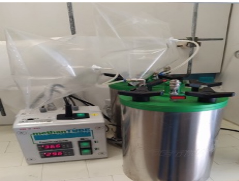
Fig. 3: Produzione di biogas in digestori portatili Methan Tube®
