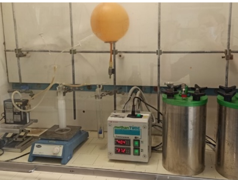
Fig. 2: Sistema di produzione del bicarbonato e carbammato d'ammonio da biogas
