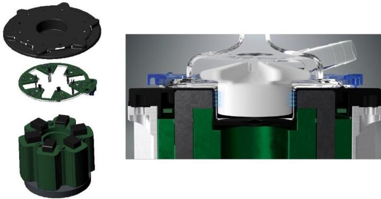
Fig. 2: sx) Esploso: posizionamento PCB con sensori a effetto Hall all'interno del motore. dx) Sezione: posizionamento girante monouso rispetto ai denti elettromagnetici dello statore
