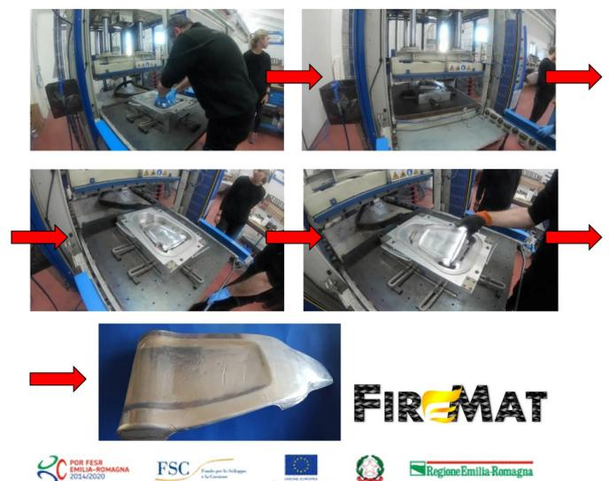
Fig. 1: Processo di pressatura a caldo di FML in forma complessa, effettuata utilizzando stampi e linea messa a disposizione dal partner del progetto Bucci Composites
