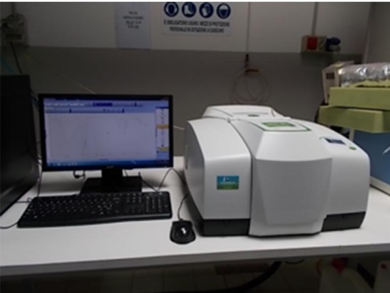
Fig. 2: Spettrofotometro FTIR con sfera integrante
