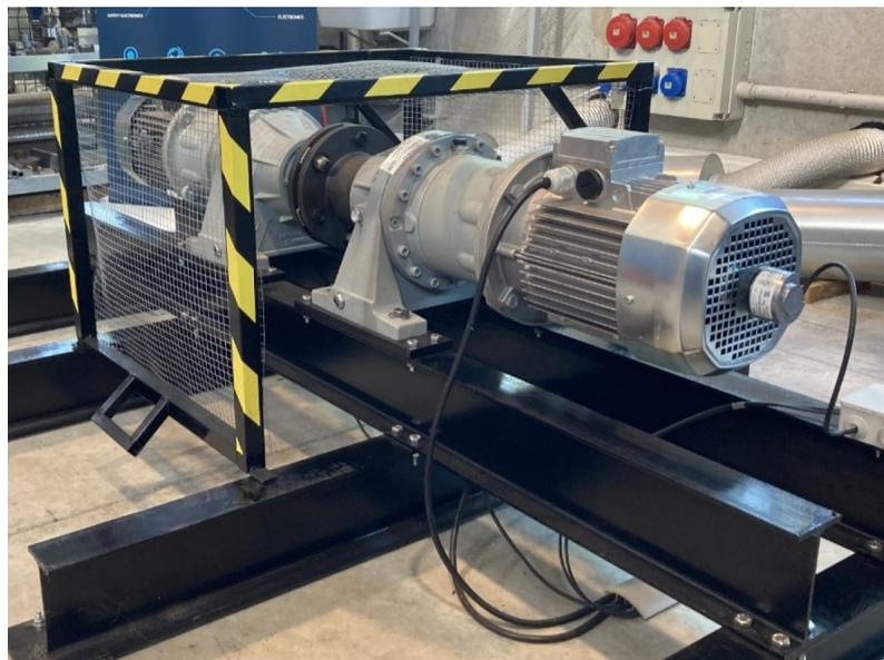
Fig. 1: Dimostratore del sistema di Diagnostica-Prognostica: validazione su motoriduttori Bonfiglioli in un banco prova back-to-back nel Laboratorio MechLav
