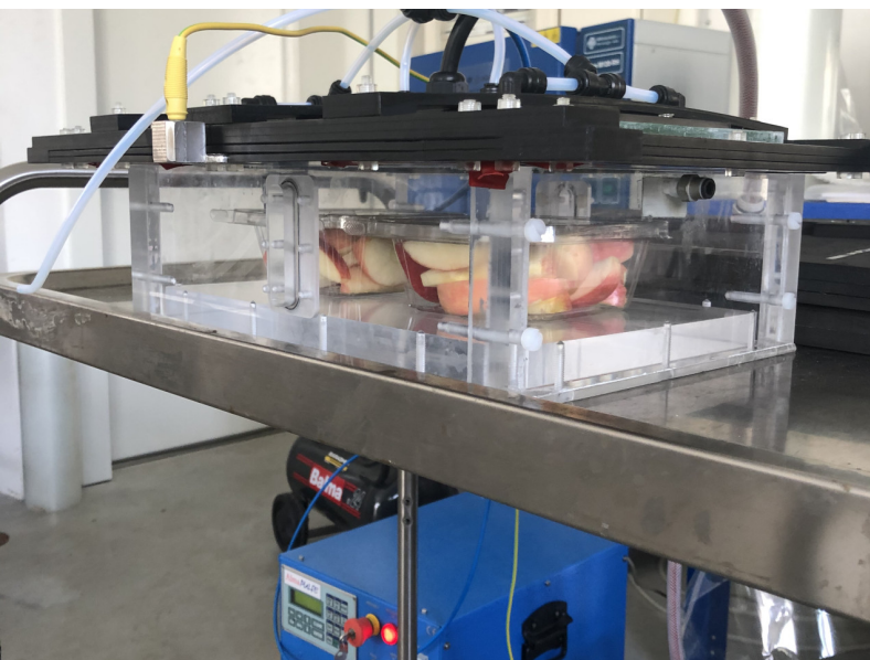
Fig. 3: Prototipo di gas plasma – Esempio di decontaminazione delle superficie di confezione di mele in IV gamma
